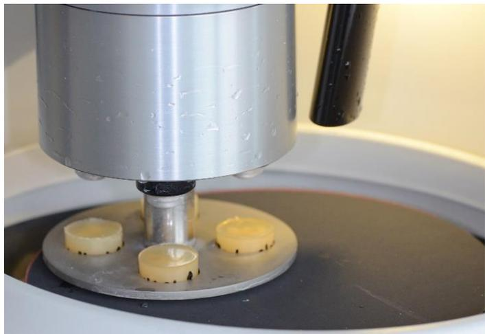
Abb. 29: Prüfkörper zum Planpolieren in Tegramin 20
