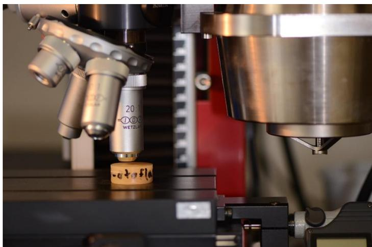
*Abb. 30: Prüfkörper bereit zur Martenshärte-Messung*
