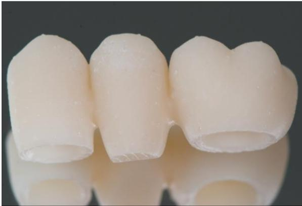
Abb. 13: fertig gedrucktes Provisorium (C&B)
