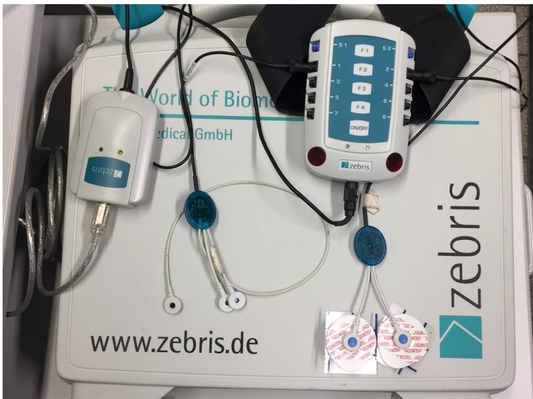
Abbildung 13: EMG-Ableitgerät der Firma Zebris. Die Messdaten werden über Kabel zum Rechner übertragen
