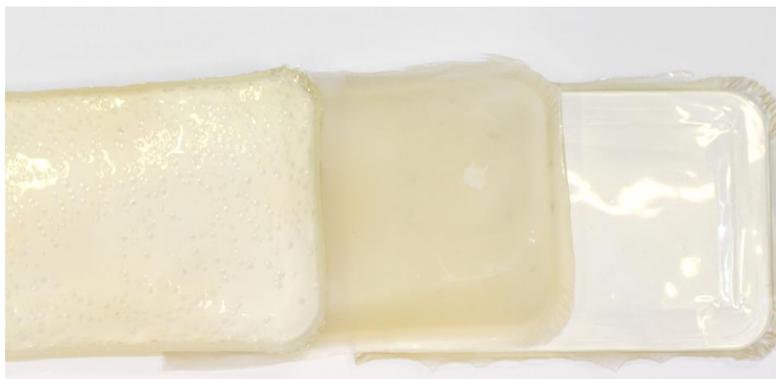
Abbildung 132: Laborfilm NC02R 0 min (links), NC02R 10 min (Mitte) und NC02R 1 h (rechts).
