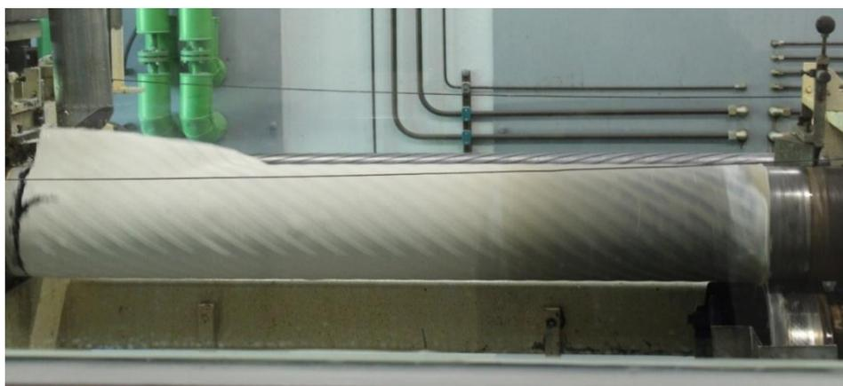
Abbildung 133: Scherwalzfell des Ansatzes Zweibasig 3\_1 auf der Scherwalze.
