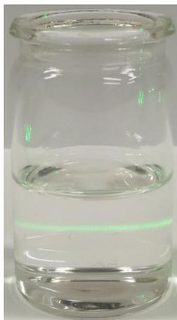
Abbildung 125: Tyndall-Effekt eine NC-Aceton Suspension nach 3h rühren.
