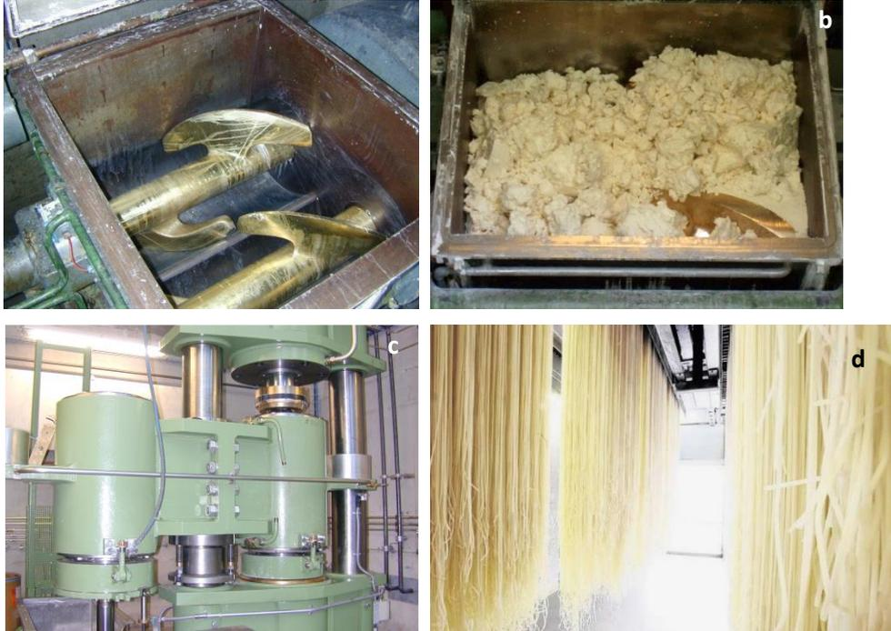
Abbildung 7: PmL Prozess mit a) Knete vor der Befüllung, b) Knete mit gelatinierendem Knetteig, c) Presse, d) gepresstes Fadenpulver in der Trocknung.<sup>[45,81]</sup>
