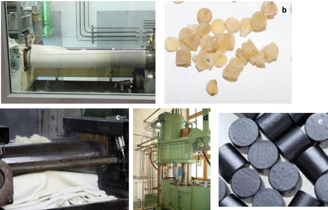
Abbildung 9: PoL Prozess mit a) Scherwalzen der Rohmasse zu b) Granulat, c) Verarbeitung von Granulat oder RM zu einem durchgehenden Walzfell, d) Pressen des Walzfalls und e) extrudierter Formkörper.<sup>[29]</sup>
