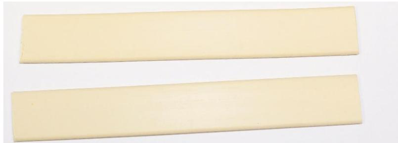
Abbildung 138: Vergleich der unterschiedlichen gewalzten Proben der Ansätze Dreibasig 1 und Dreibasig 2.
