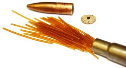
Abbildung 2: Kordit-Schnüre einer .303 British britischen Gewehrmunition.<sup>[15]</sup>
