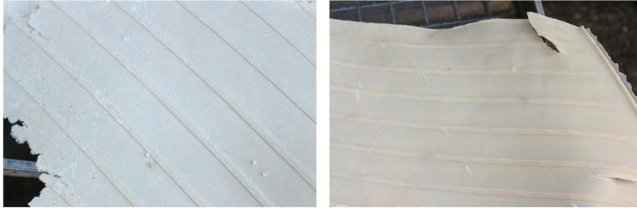
Abbildung 137: Vergleich Aufgabenseite zu Granulatorseite des dreibasigen Scherwalzversuchs.
