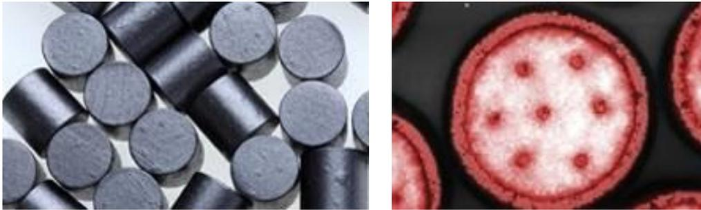
Abbildung 3: Zylindrisch geformtes Treibladungspulver mit graphitierter Oberfläche für Großkaliberanwendungen<sup>[29]</sup> (links), Querschnitt eines 7-Loch Pulvers<sup>[30]</sup> mit Oberflächenbehandlung für Kleinkaliber (rechts).
