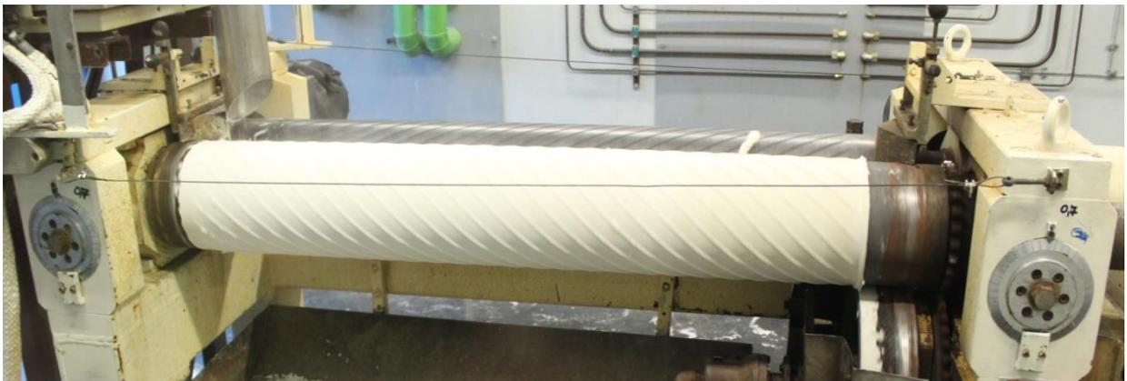
Abbildung 136: Scherwalzfell des Ansatzes Dreibasig 2\_2 auf der Scherwalze.
