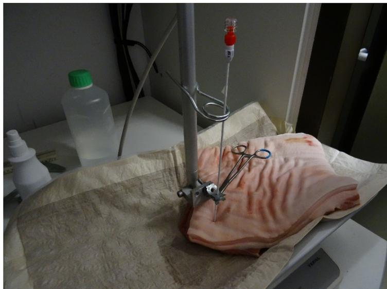
Abb. 29 ReSolve Drainage-Katheter 7,5 F bei Gewebepenetration mit 11,2 N (A) bzw. 23,5 N (B), Eigenaufnahme mit digitaler Kamera
