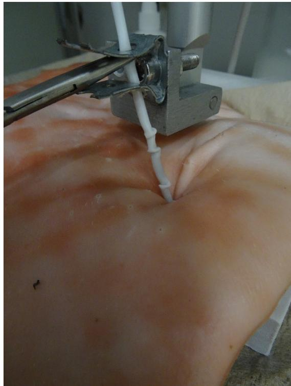
Abb. 37 ReSolve NL 10 F bei Gewebepenetration mit 45 N, Eigenaufnahme mit digitaler Kamera
