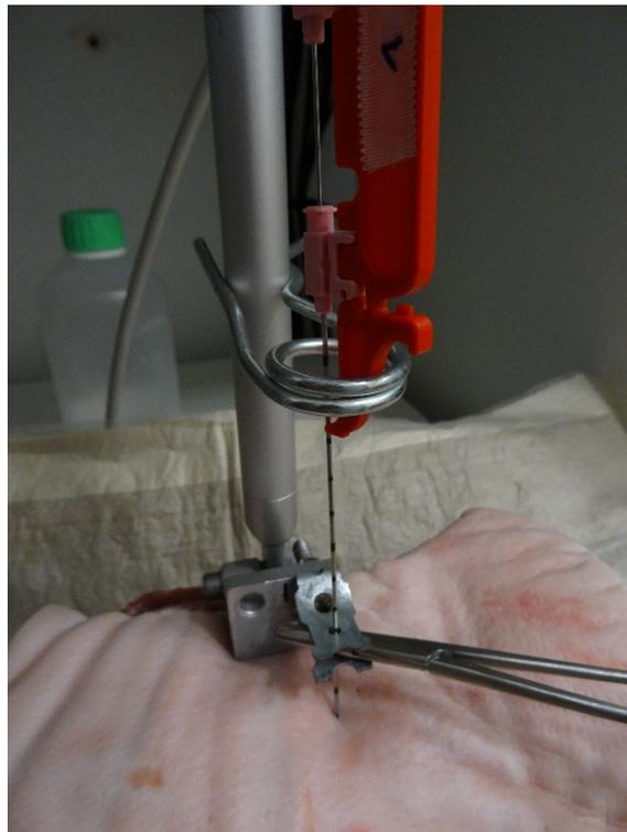
Abb. 48 Magnum 18 G bei Gewebepenetration mit 9,1 N, Eigenaufnahme mit digitaler Kamera
