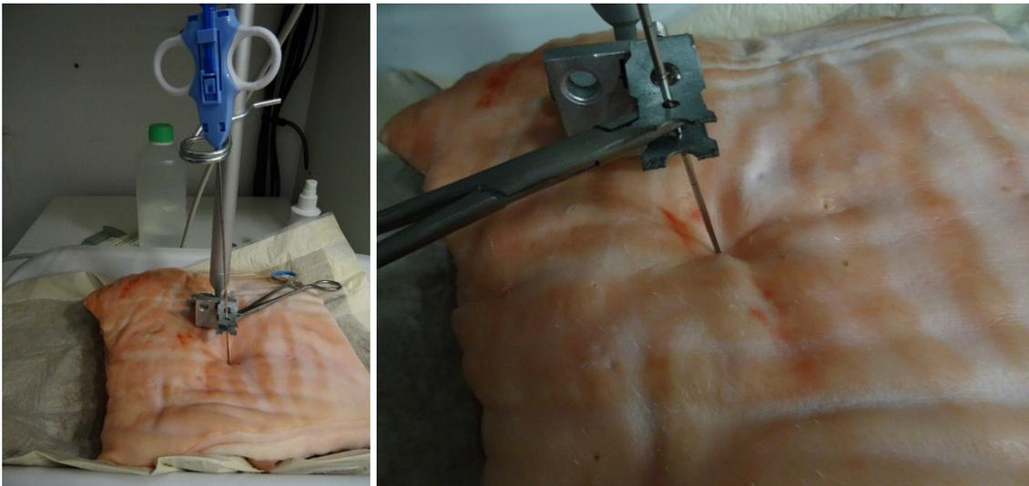
Abb. 49 Coaxial Temno Evolution 16G bei Gewebepenetration mit 1,6 N (links) und 14 N (rechts)
