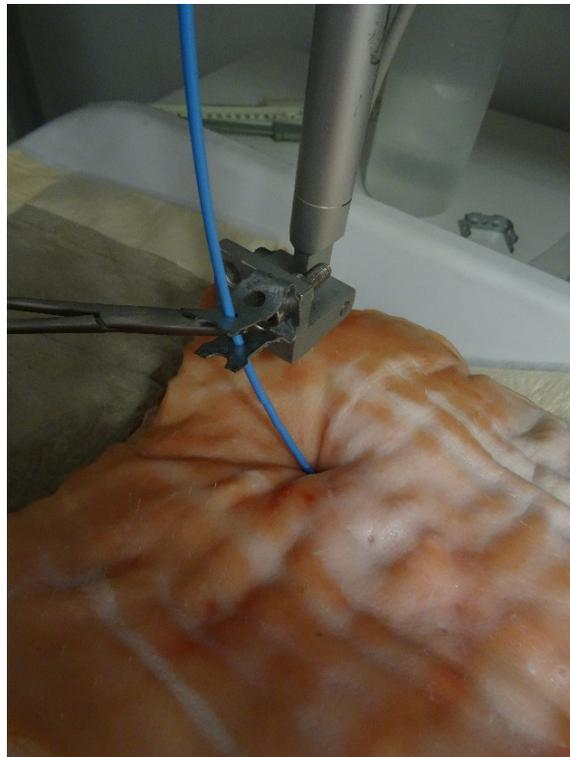
Abb. 31 Flexima 8F bei Gewebepenetration mit 24,9 N, Eigenaufnahme mit digitaler Kamera
