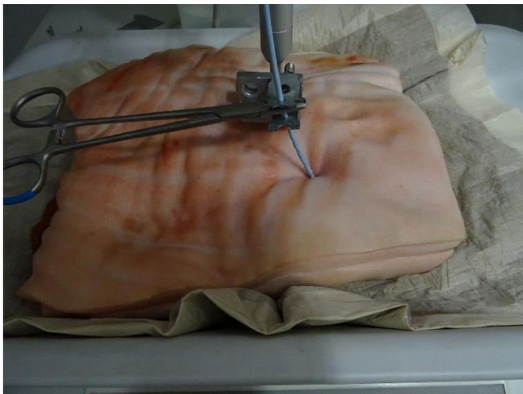
Abb. 33 Plusdrain 8,3 F bei Gewebepenetration mit 31 N, Eigenaufnahme mit digitaler Kamera
