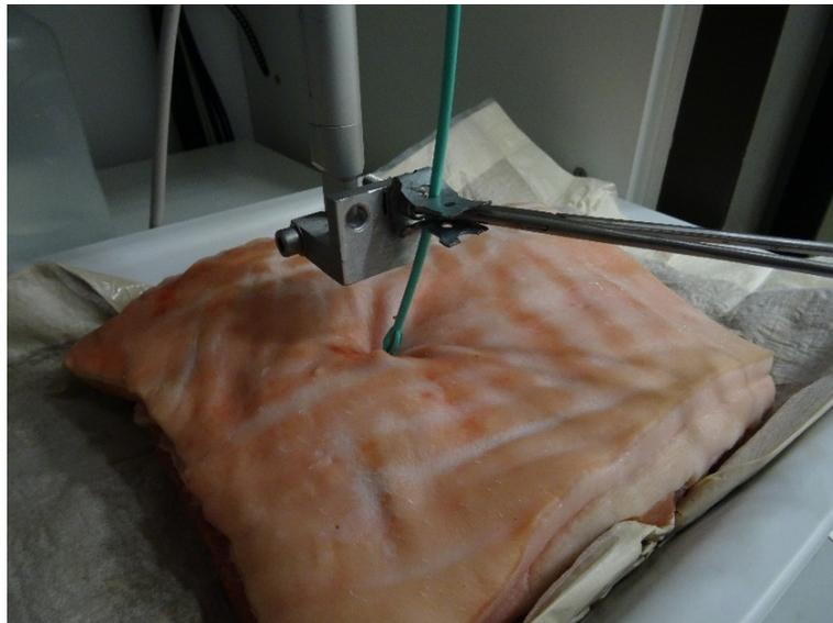
Abb. 35 Basketplus 10F bei Gewebepenetration mit 26 N, Eigenaufnahme mit digitaler Kamera
