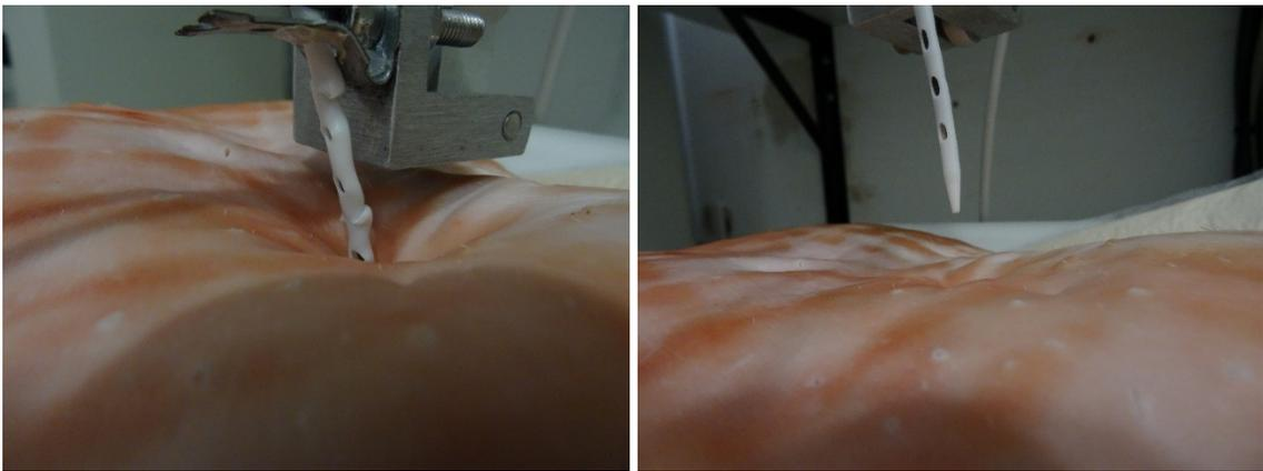
Abb. 41 ReSolve NL 12F bei Gewebepenetration mit 45 N (links), nach Entfernung aus Stichkanal (rechts), Eigenaufnahme mit digitaler Kamera
