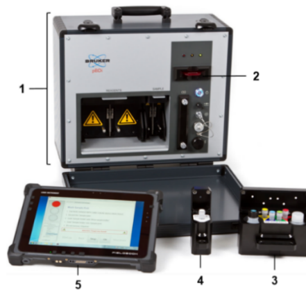
Abbildung 7: Mikroarray-basierte Vor-Ort-Detektionsplattform pBDi.
