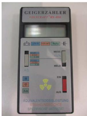
Abb. 2-2 Voltcraft HS-036 mit vierstelligem LCD
