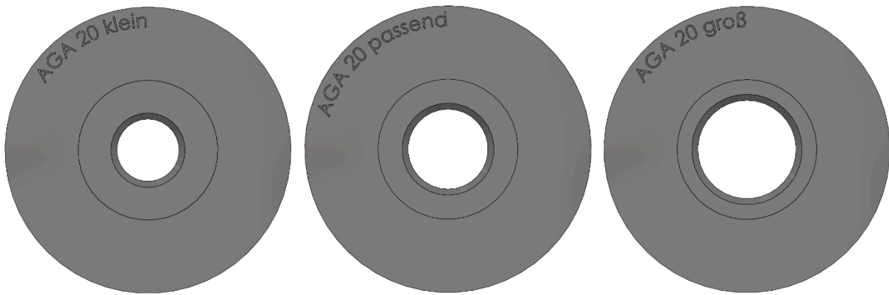
Abbildung 13: Beispiel der drei Defektgrößen mit den Durchmessern 15,2 mm, 19,5 mm und 24,0 mm für den AMPLATZER Septal Occluder 9-ASD-020
