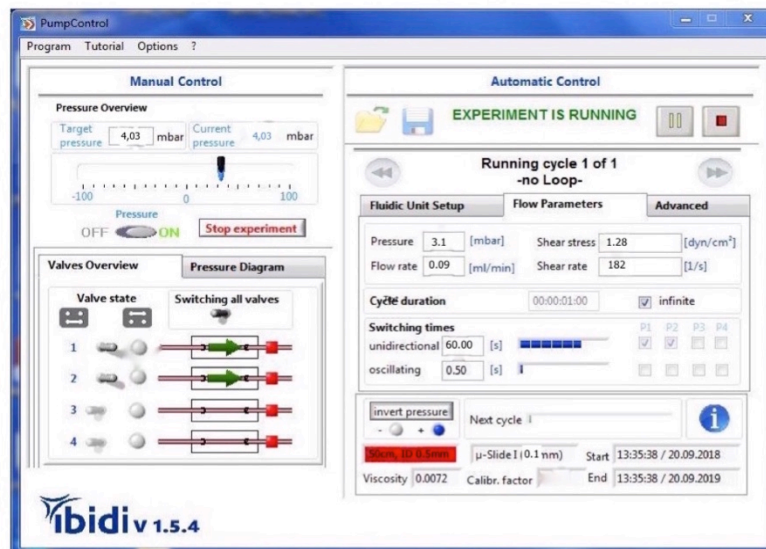
Abbildung 12 : PumpControl System – Einstellungen der Parameter
