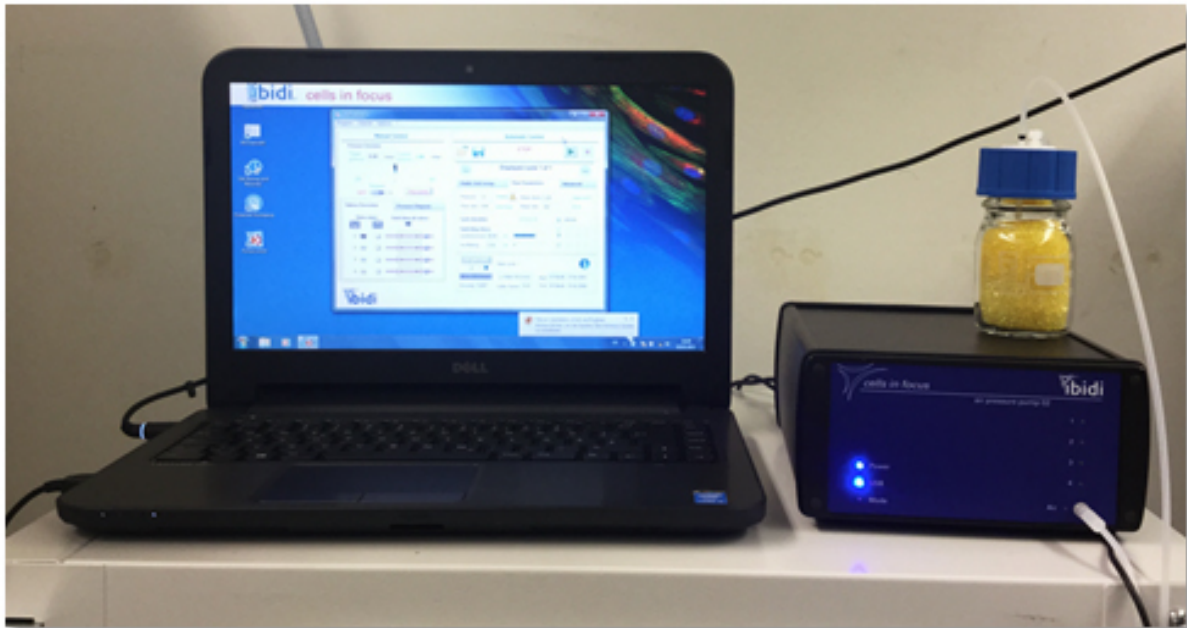
Abbildung 11: Das System besteht aus: der Pumpe selbst (re.), einem Computer für das Pump Control System (li.), einer Trockenflasche (gelb), Luft-Zufuhr-Schläuchen und einem elektrischen Verbindungskabel
