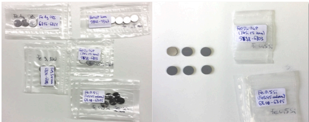
Abbildung 2: Vakuumpackete Aufbewahrung der Metalle vor dem Versuch (re.) und Plättchen vor der Sterilisation im Heißluftsterilisator (li.)
