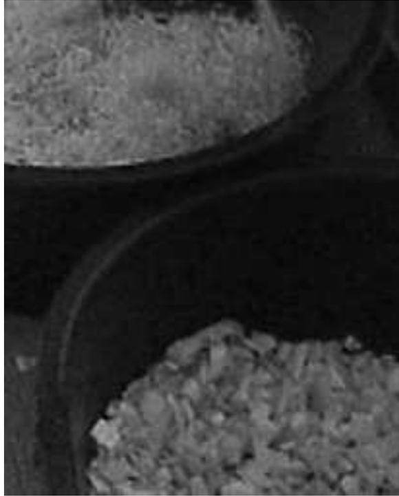
**Abbildung 3.9: Füllmaterialien Holzwolle mit feiner (links oben) und mit grober (rechts unten) Struktur**
