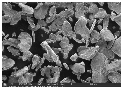
(a) SEM of Mg (Grüssing GmbH, 99 %).
