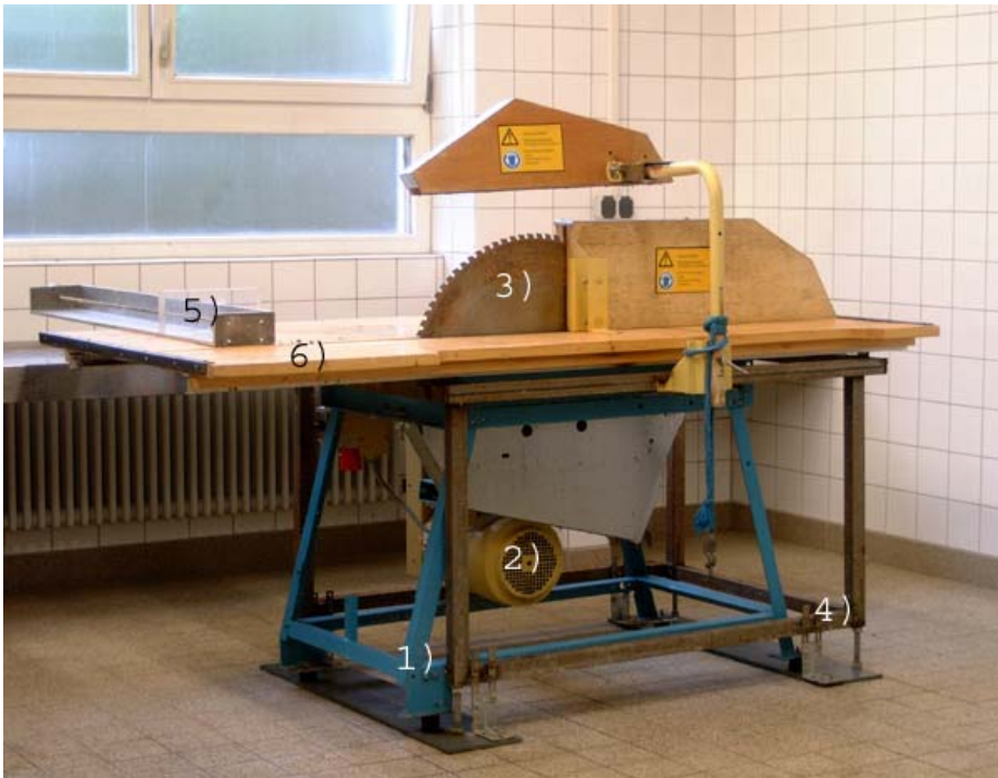
Abb. 4: modifizierte Brennholzkreissäge (Scheppach KE 70) als Kryomakrotom:
