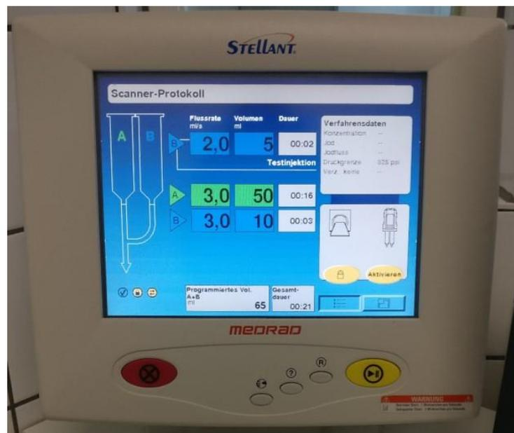
**Abbildung 18:** Der Touchscreen-Monitor, worüber die KM-Pumpe vom Kontrollraum aus programmiert und gesteuert werden konnte. Die blauen Kästchen mit der Kennzeichnung B gaben dabei die Injektionsrate (ml/s) und die Menge (ml) von NaCl vor und nach der Injektion von Kontrastmittel (in den grünen Kästchen, A) an.
