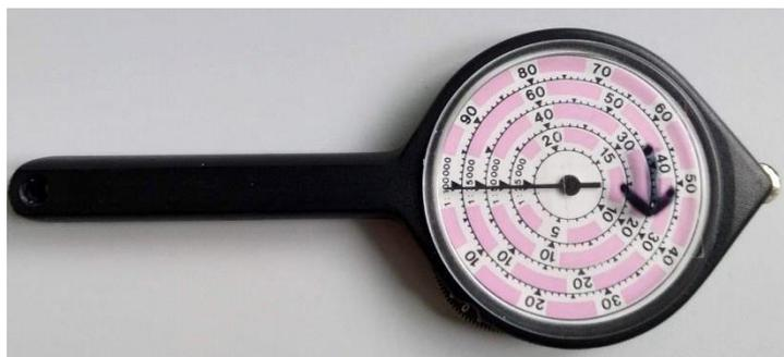
Abbildung A 15: Kartenmesser, wie er in dieser Arbeit zur Vermessung der Länge aller Stufenkanten eines jeden STM-Bildes verwendet wurde.
