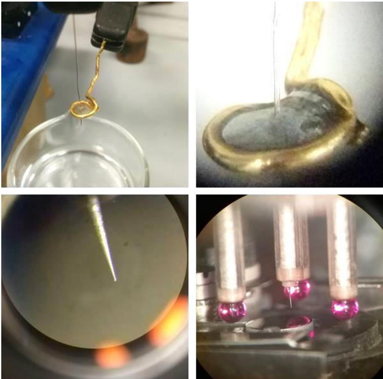
Abbildung A 5: Ätzen einer Pt/Ir-Spitze aus einem 0,25 mm dicken Draht, (a) Ätzvorrichtung mit Öse aus Gold als Gegenelektrode; (b) Gasentwicklung am Pt/Ir-Draht bei angelegter Rechteckspannung (c) die neue Pt/Ir-Spitze unter der Stereolupe; (d) Messkopf (*beetle*) mit neuer STM-Spitze.
