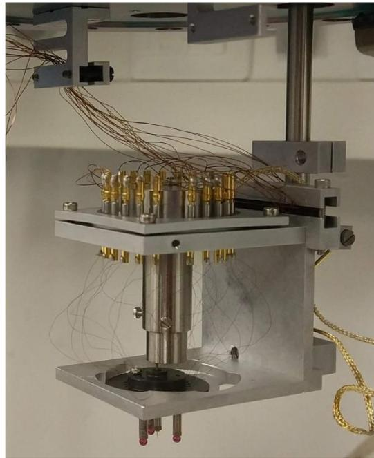
Abbildung 3.6: STM-Bühne, die an einem Lineartransfer aufgehängt ist, wodurch ein Absetzen und Abheben des Messkopfes (*beetles*) auf dem Probenträger möglich ist. Erkennbar sind die elektrischen Anschlüsse der Piezos (oberer Kranz und Kabel), das geschirmte Kabel für den Tunnelstrom (rechts) und der Messkopf (schwarze Scheibe und Piezos mit Rubinkugeln).
