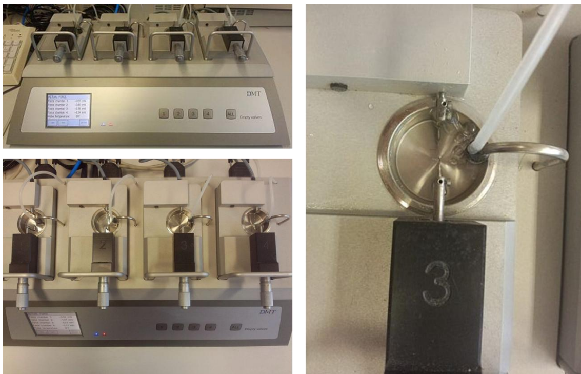
Abb. 3: Organbad. Gezeigt ist das hier verwendete Organbad des Herstellers „Danish Myotechnology“ („Multi WireMyograph System, Modell DMT720M“). Man sieht vier voneinander getrennte Kammern, die jeweils ein Fassungsvermögen von ca. 10 ml haben. Jede
