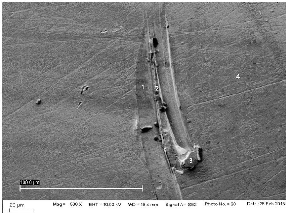
**Abb. 66** REM-Detaillaufnahme eines gefrästen Primärteils nach 10.000 Verschleißzyklen bei 500facher Vergrößerung
