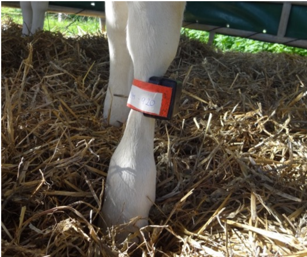
Abbildung 9: Accelerometer, lateral am linken Hinterbein eines Mastbullenkälbes angebracht zur Aufzeichnung von durch Schmerz oder Stress beeinflussten Aktivitätsparametern nach prophylaktischer Gummiring-Schwanzspitzenamputation
