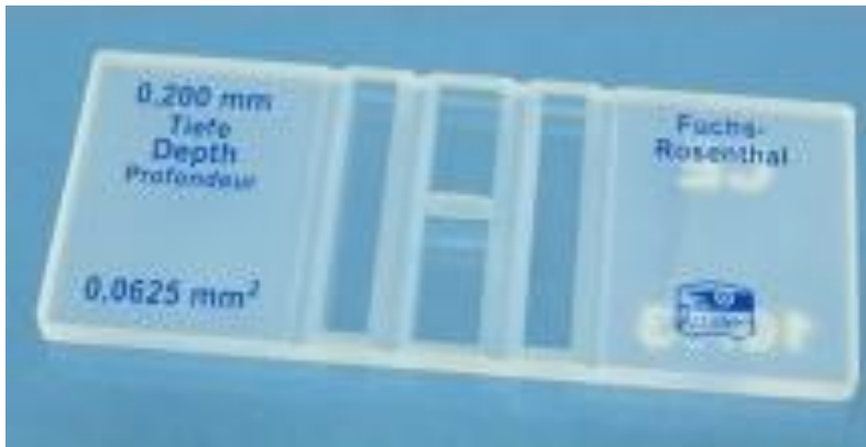
Abb. 2: Modifizierte Neubauer Zählkammer zur Bestimmung der Zellzahl; die Platte besteht aus zwei breiten Außenfeldern und drei schmalen Innenfeldern. Im mittleren Innenfeld befindet sich der Mittelsteg, in diesen sind zwei Zählnetze eingraviert (übernommen aus P+W Medizintechnik, 2012).
