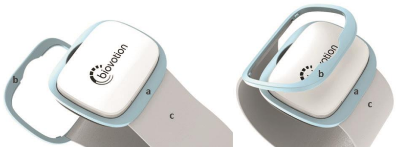
Abbildung 7: Das Befestigungssystem des vsm-1 beinhaltet zwei Fassungen aus Kunststoff (a, b) und ein elastisches Band (c) (modifiziert nach BIOVOTION 2018a. Mit freundlicher Genehmigung der Biovotion AG, Zürich, Schweiz).
