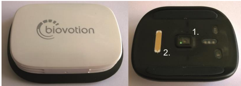
Abbildung 8: Der Biovotion Vitaldatenmonitor vsm-1 und seine Sensoren. Diese beinhalten den optischen Sensor (1.) und die GSR-Elektrode (2.) sowie weitere Sensoren im Inneren des Geräts (BIOVOTION 2016a, 2016b).
