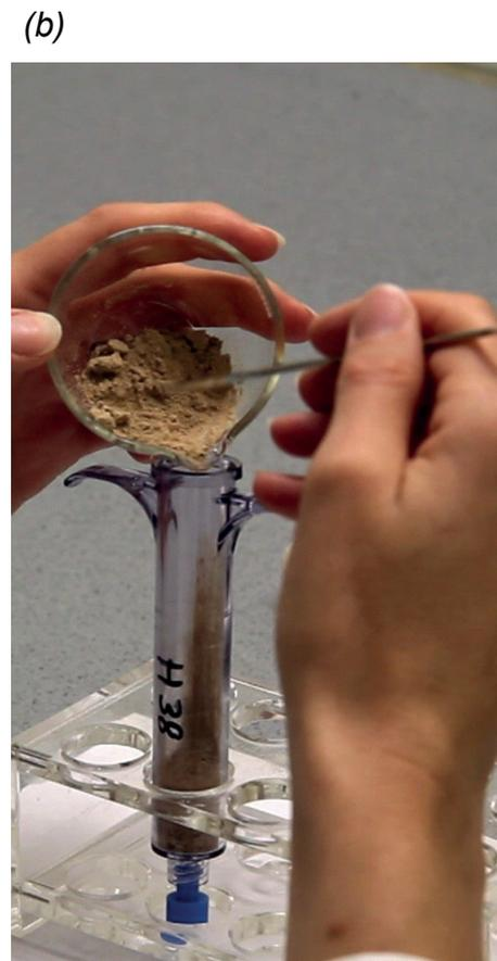
Abbildung 5: Füllung der Polycarbonat-Hochdruck-Spritze (CCSB911, Merit Medical, South Jordan, Utah, USA) mit der Drogenprobe (a) Kokain mit 78% Konzentration (K78) und (b) Heroin mit 38% Konzentration (H38), an der Vorderseite der Spritze jeweils Verschluss mit einem Combi Stopper Verschlusskone in blauer Farbe (B. Braun Melsungen AG, Deutschland).
