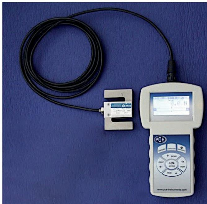
Abbildung 8: Elektronischer Präzisionskraftmesser (PCE- FG 1k, PCE Deutschland GmbH, Meschede, Deutschland) zur Messung der eingesetzten Kompressionsdrücke mit einem Messbereich bis 1000 Newton.
