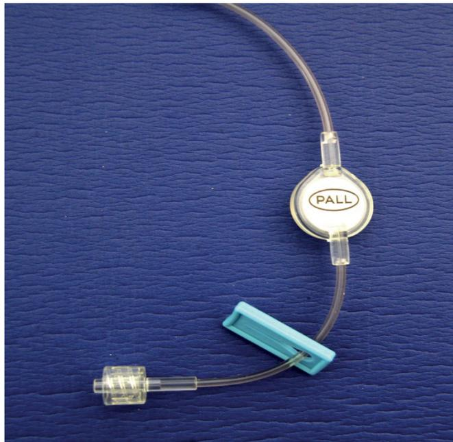
Abbildung 7: Bakterienfiltersystem (Bakterienfilter, PALL Corporation, Porengröße 2  $\mu\text{m}$ ) zur Entlüftung/Überdruckabbau an der Vorderseite der Hochdruck-Spritze befestigt zur Verhinderung eines Drogenaustritts. Mit dem Bakterienfilter war die Konstruktion für Partikel der Drogenproben von einer Größe über 2  $\mu\text{m}$  gegenüber der Raumluft nicht durchlässig.
