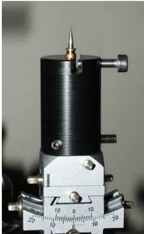
Justiernadel mit Adapter auf Goniometerkopf
