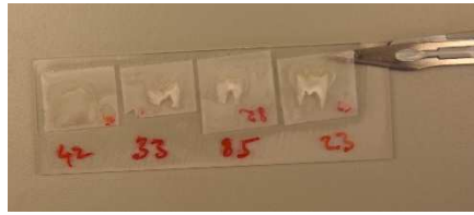
Fixierte Proben auf Probenträger (entfernbar)
