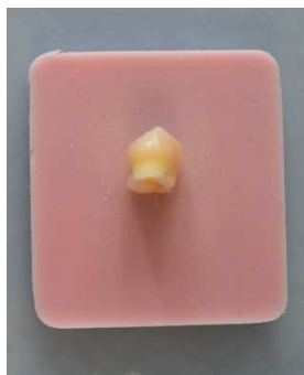
Zahn am Boden der Einbettform fixiert
