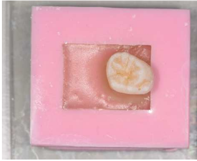
Fixierter Zahn im Sägeblock
