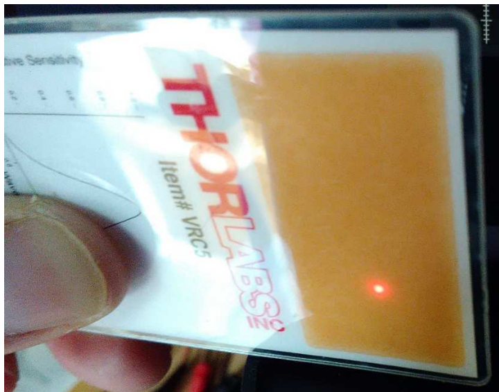
Detektorkarte: Einstellung der Fokussierung
