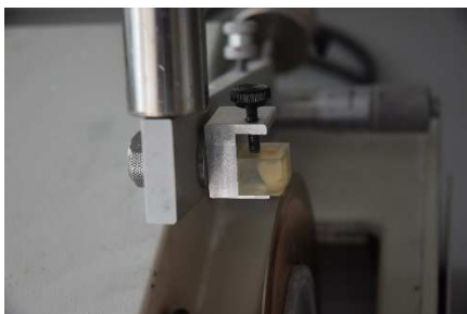
Eingespannter Block in Isomet Kreissäge
