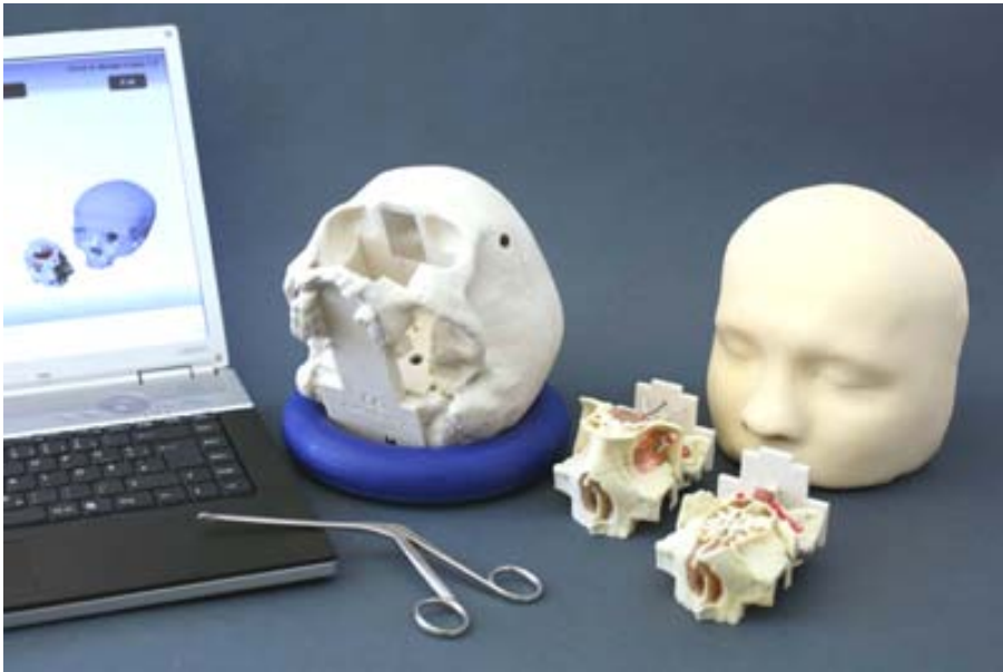
Abb. 5.2.: Prototyp eines Trainingssystems der HNO Klinik der Universität Leipzig für Eingriffe an der Rhinobasis mit optoelektrischer Fehlerdetektion und Protokollierung 129
