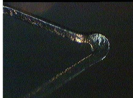
**Abbildung 2:** Palmaz-Schatz® Stent; hier abgebildet eine Metallstabschleife an den Enden des Stents [50fache Vergrößerung].
