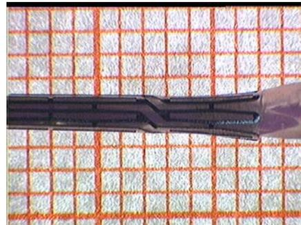
**Abbildung 4:** Ballonmontierter Palmaz-Schatz® Stent mit 1 atm inflatiert [10fache Vergrößerung].
