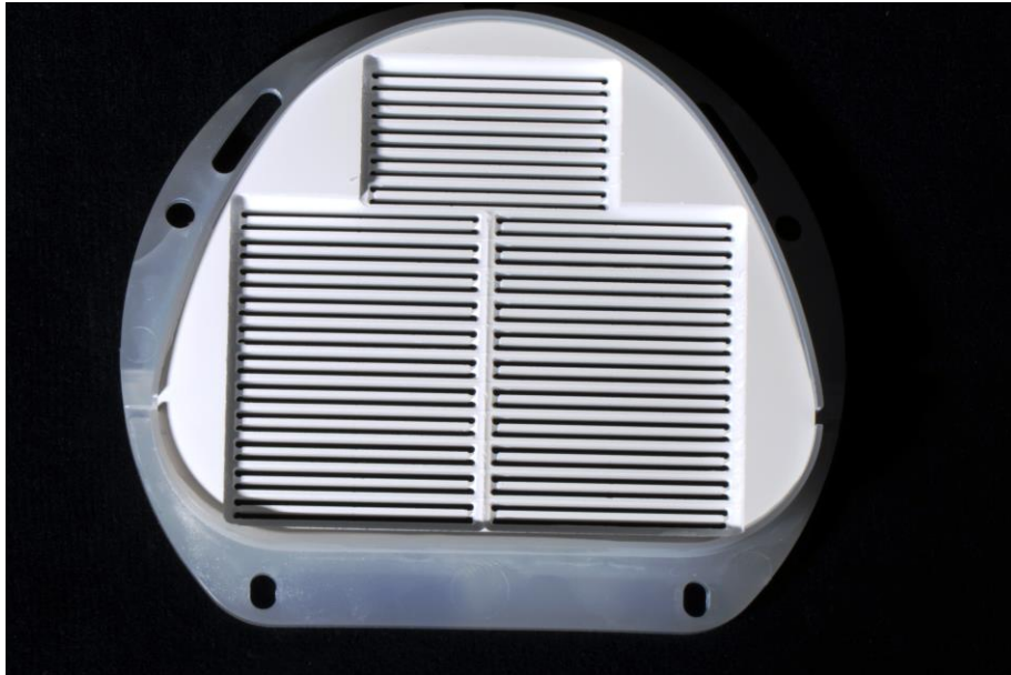
Abbildung 8: Zirkonoxid-Rohling nach dem Fräsen; die Prüfkörper wurden noch nicht heraus getrennt
