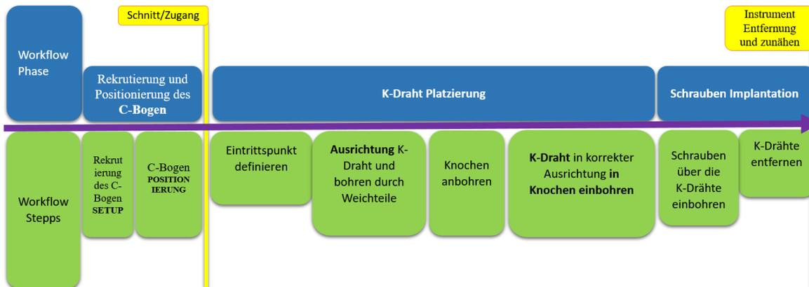
Abb. 4: Schematische Darstellung der Arbeitsschritte zur Platzierung einer Schraube mit Hilfe eines K-Drahtes bei der minimal-invasiven Behandlung einer nicht dislozierten Beckenfraktur.
