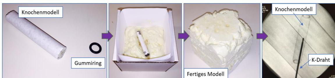
Abb. 15: Schema zur Herstellung des Modells und Darstellung im Röntgenbild.
