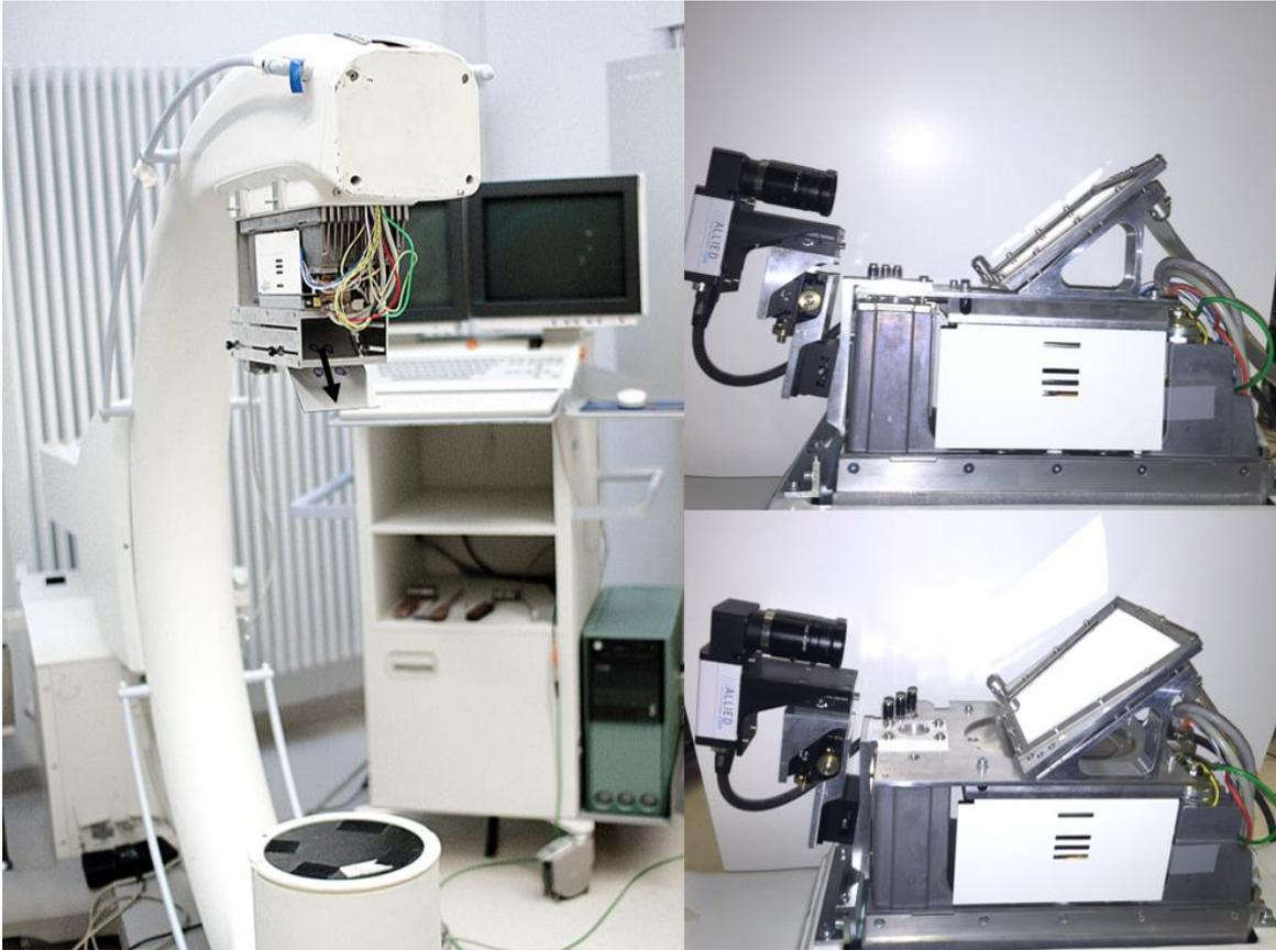
Abb. 7: „CamC“ Prototyp mit C-Bogen in „upside-down“ Konfiguration (links) und Detailansicht der Kamera- und Spiegelkonstruktion (rechts).
