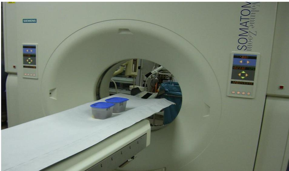
Nach Positionierung der Präparate in den wassergefüllten Boxen, wurden diese wiederum zur Minimierung der Lufteinschlüsse 24 h vor der Messung bei 50 mbar in die Unterdruckkammer gestellt (*siehe Kap. 4.5*).
