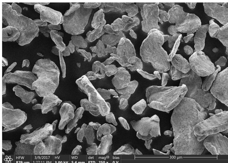
**Figure S2. SEM of Mg (Grüssing GmbH, 99%).**
