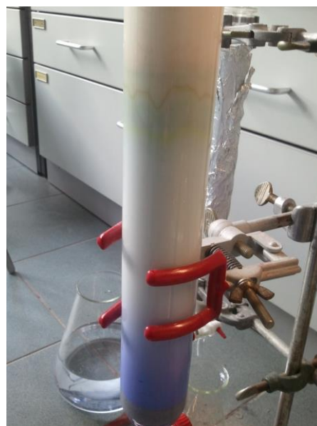
Abb. 14: Säulenchromatographische Aufreinigung von Azulen.
