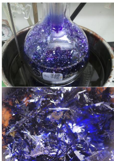
Abb. 18: Über Sublimation aufgereinigtes Azulen mit Apparatur (oben) und Großaufnahme (unten).
