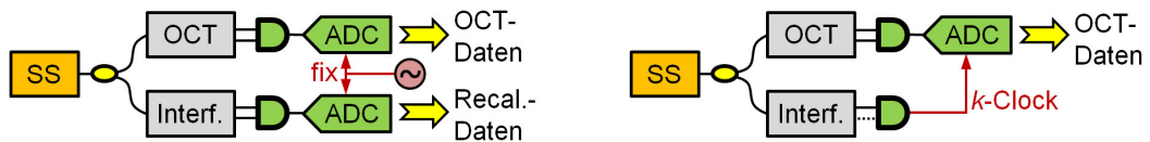
Abbildung 12: Schematischer Aufbau für k -Clocking (rechts) und sowie für nachträgliche numerische kontinuierliche Rekalibrierung (links). In beiden Fällen wird ein Teil des Lichts der durchstimmbaren Lichtquelle (SS) in ein dezidiertes Interferometer (Interf.) geleitet. Beim k -Clocking erzeugt das Interferometer direkt ein Taktsignal für die Datenerfassung im ADC, während bei der numerischen Rekalibrierung dieses Signal ebenfalls per ADC digitalisiert wird und anschließend digital verarbeitet.
