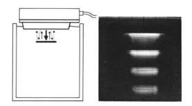
Abb. 2.15: Entstehung von Wiederholungsechos aufgrund einer stark reflektierenden im Nahbereich des Schallkopfes liegenden Struktur; aus Dudwiesus (1987)
