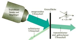
(a) Schematische Darstellung der Reflexion und Transmission
