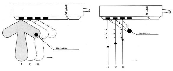
(a) Erfassung einer reflektierenden Struktur durch die Nebenkeule eines Schallfeldes
