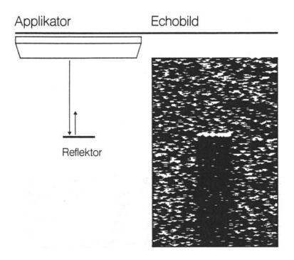
Abb. 2.16: Schallschattenartefakt: Bei starken Reflektoren wird der hinter der Struktur liegende Bereich nicht mehr von Schallimpulsen erreicht, und somit nicht abgebildet. An der Stelle des Reflektors entsteht ein starkes Echo mit dahinterliegendem echofreiem Raum; aus Graf und Schuler (1995)
