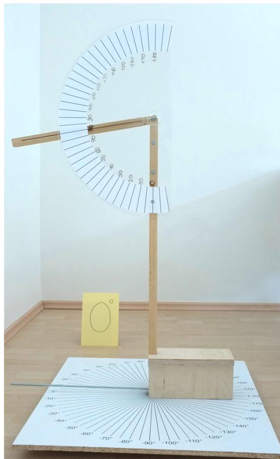
**Abbildung 34:** Gerät zur Simulation der Achsverhältnisse am Femur unter Rotationseinfluss.
