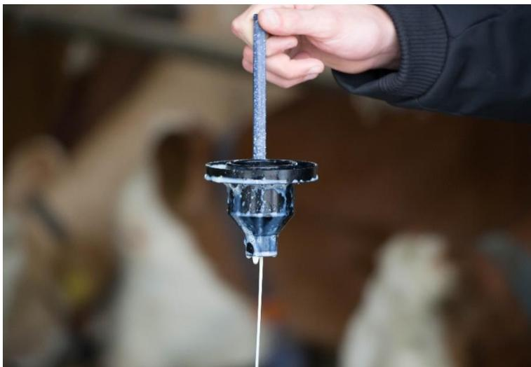
Abbildung 9: Durchführung der Trichtermessung mit seitlich angeklebtem Haltegriff
