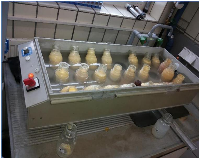
Abbildung 3: Wasserbad des LKV-Labors zur Erwärmung der aufgetauten Proben auf 30°C
