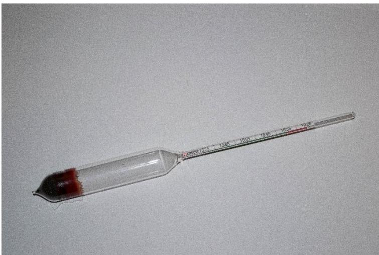
Abbildung 7: Kolostrometer der Firma Kruuse in DK-5550 Langeskov
