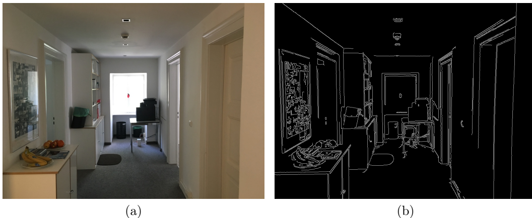
Abbildung 4.1: Anwendung eines Kantendetektors auf ein Standortbild: (a) Standortbild vor der Anwendung des Kantendetektors - (b) Standortbild nach Anwendung des Kantendetektors: Türrahmen und Fensterrahmen werden deutlich hervorgehoben.
