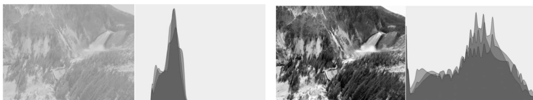
(a) Histogrammequalisierung: Verteilung der Grauwerte ohne Equalisierung (b) Histogrammequalisierung: Verteilung der Grauwerte nach der Equalisierung
