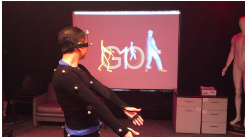
Abbildung 2.11: Beispiel eines Motion Caputres mit Markern. Die weißen Kugeln an der Person werden zur Aufzeichnung der Bewegung verwendet [99].
