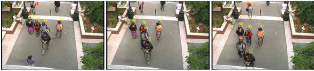
Abbildung 2.10: Aufzeichnung eines visuellen Tracking-Systems: (Von links nach rechts) Personen werden über die drei Bilder hinweg erkannt und verfolgt. Jedes Objekt wird mit einer schwarzen Ellipse und einem eindeutigen Index (gelb) gekennzeichnet [96].
