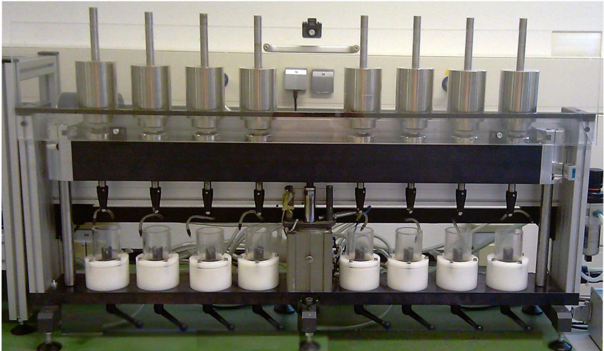
Abbildung 4: Kausimulator „Münchner Modell Muc 2“, Fa. Willytec, München
