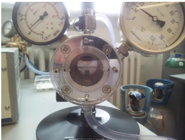
Abbildung 5: EMITECH Kritisch-Punkt-Trockner Quelle: GaLa Gabler Labor Instrumente Handels GmbH
