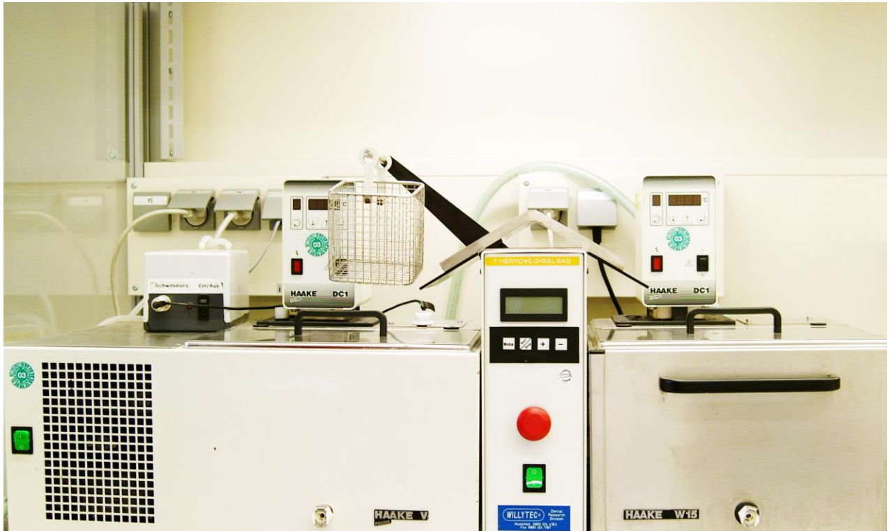
Abbildung 3: Thermowechselbad Haake W 15, Firma Willytec München
