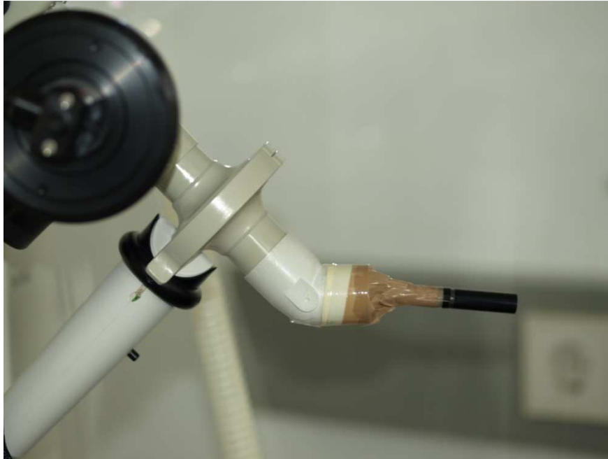
Abb. 9: Endgültige Konstruktion zur spirometrischen Messung
