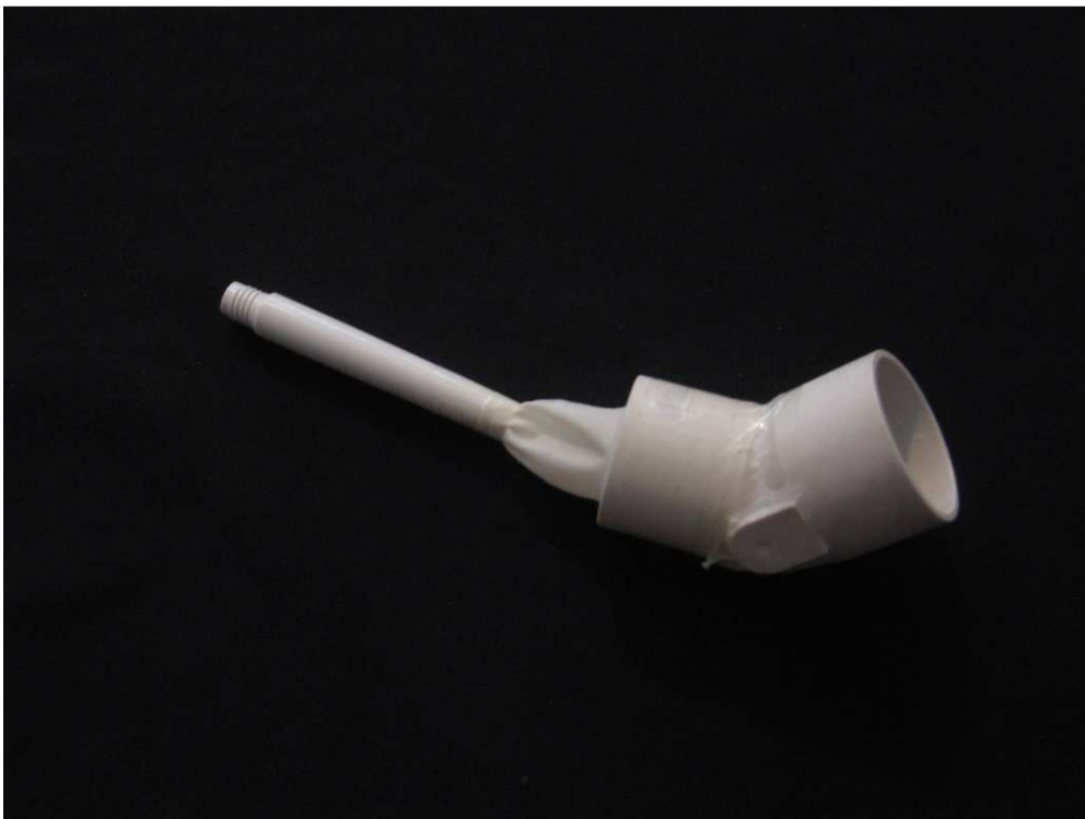
Abb. 8: Konstruktion aus Kugelschreiberhülse und Mundstück
