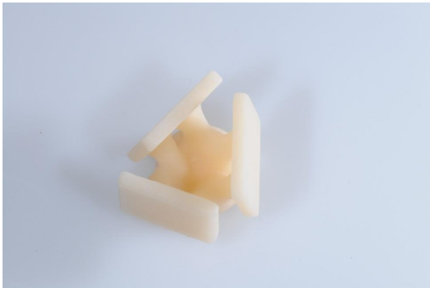
Abbildung 13. Prüfkörper nach der Grob- und Feinausbettung
