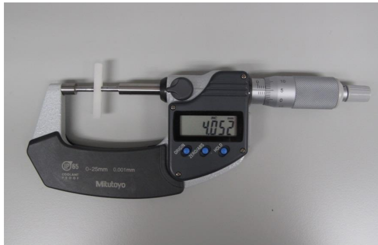
Abbildung 11. Vermessen der Prüfkörper mit Hilfe einer digitalen Bügelmessschraube.
