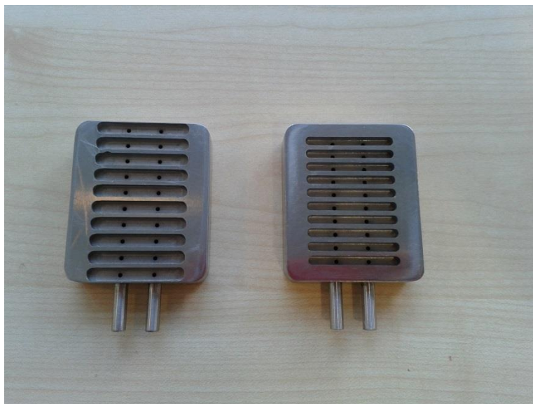
Abbildung 10. Stahlvorrichtung für die Politur der Prüfkörper.
