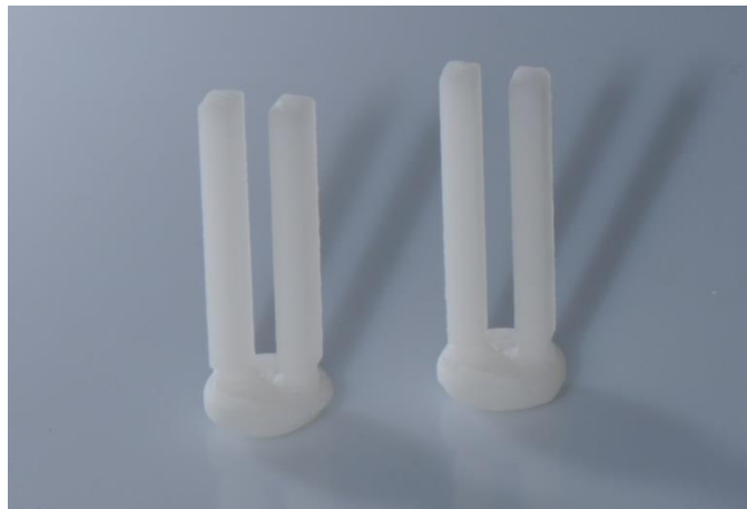
Abbildung 9. Prüfkörper nach der Grob- und Feinausbettung.
