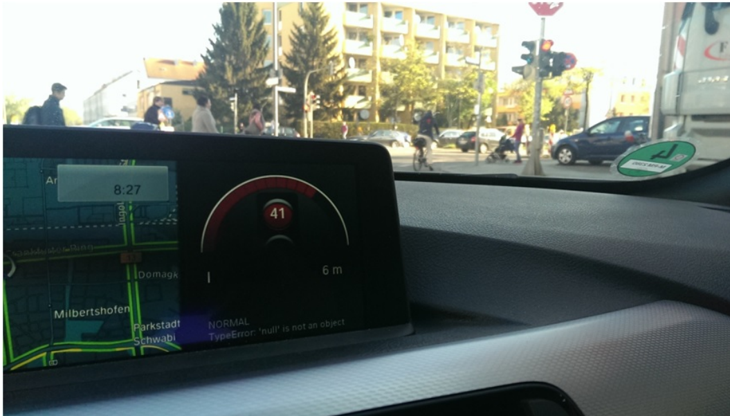
Abbildung 3.7: Ausblick: HMI-Vorschlag für die Nutzung der Schaltzeitprognosen mit der Kundenfunktion „Restrotanzeige“ an der Kreuzung Ingolstädterstr./Frankfurter Ring in München. Zu sehen ist ein Signalgeber mit dem Signalzustand rot und eine Restrotanzeige in einem Versuchsträger der BMW Group.
