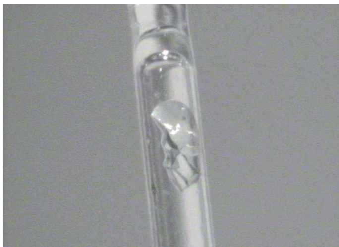
Abbildung 38: Kapillare mit \text{SO}_2\text{F}_2 \cdot \text{SiF}_4 (Festphase) und einem Gemisch aus \text{SOF}_4 und Abbauprodukten (Flüssigphase).
