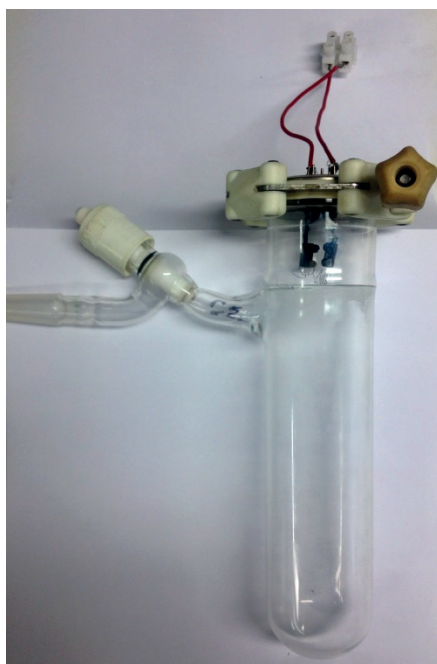
Abbildung 64: Verbrennungsreaktor aus Glas mit elektrischer Durchföhrung und Tantalfilament.
