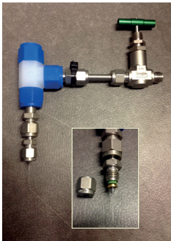
Abbildung 51: Vakuumlinienadapter für korrosive Gase (6 mm Svagelok® auf 0.1 mm Kapillare).
