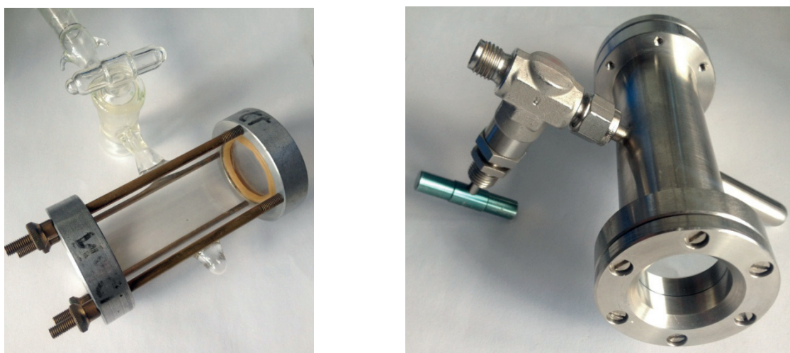
Abbildung 60: Gas-IR-Küvette aus Glas mit NaCl-Fenster (links) und Edelstahl mit Si-Fenster (rechts).
