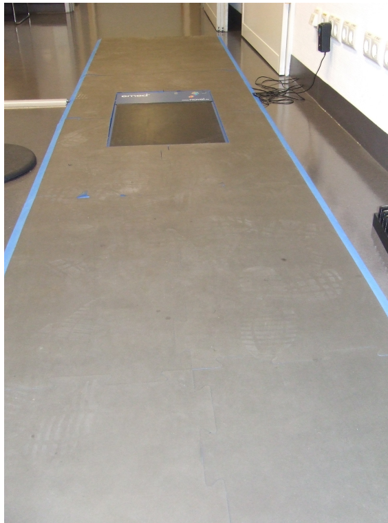
Abbildung 6: Aufbau der baropedographischen Messeinheit
