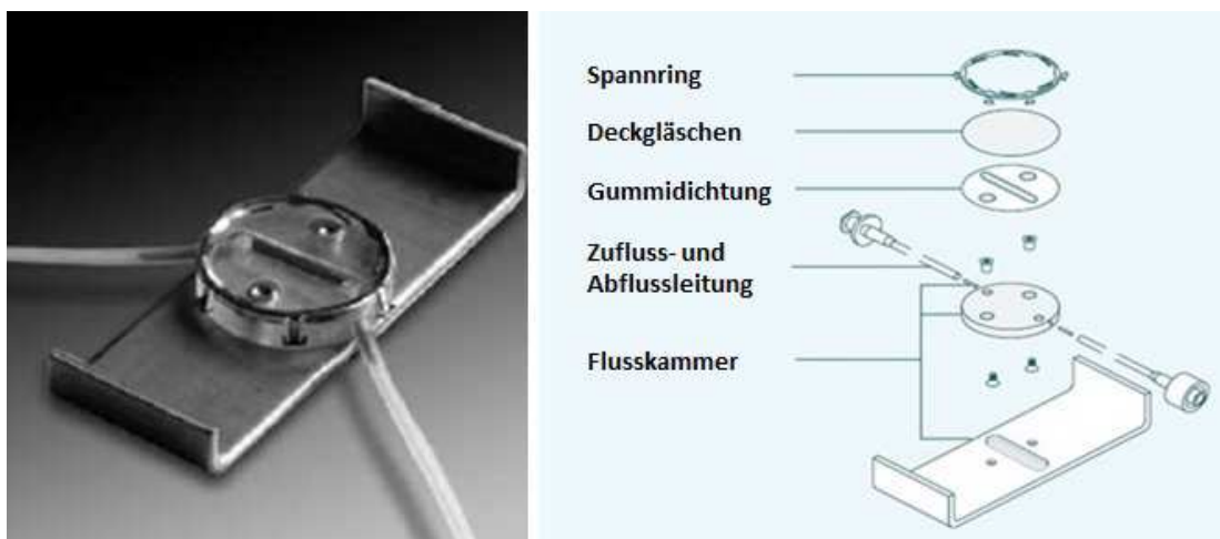
Abbildung 29: Aufbau der Flusskammer (Abbildung mit freundlicher Genehmigung der Provitro AG, Berlin; Abbildung modifiziert nach 358 )
