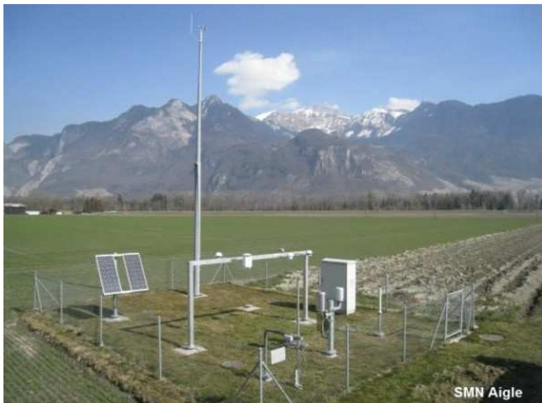
**Abbildung 3: Messfeld-Station in Aigle mit 10 m hohem Windmasten, einer Messbrücke auf 2 m (Temperatur, Feuchtigkeit und Strahlung) und einem Pluviometer (Niederschlag), 1,5 m über Boden (BUNDESAMT FÜR METEOROLOGIE UND KLIMATOLOGIE METEOSCHWEIZ, 2014c)**
