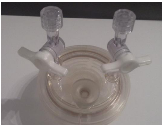
Abb. 16 Bioreaktor-Vessel der Firma Synthecon mit 3 Öffnungen zur Befüllung und semipermeabler Membran auf der Rückseite zum Gasaustausch: a) Vorderseite, b) Rückseite
