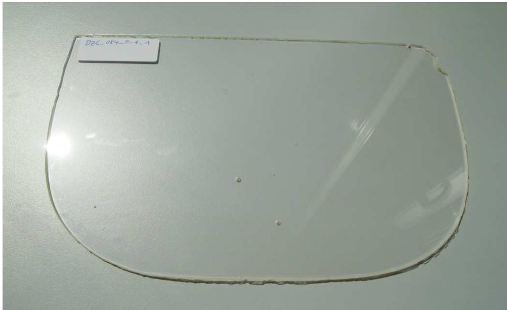
Abbildung 92: In PMMA eingearbeitetes 46b (900 ppm); die gesammelte gelborangefarbene Fluoreszenz ist schwach an der Kante zu erkennen. Fotoaufnahme bei direkter Sonneneinstrahlung.
