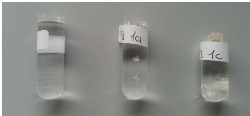
Abbildung 98: In PMMA eingearbeitetes 46e. V. l. n. r.: 10 ppm 46e, 50 ppm 46e, 150 ppm 46e. Fotoaufnahme bei Tageslicht. Bei Probe 150 ppm ist die gesammelte gelborangefarbene Fluoreszenz schwach an der oberen Spitze zu erkennen. Probe 10 ppm und 50 ppm zeigen optisch kaum Unterschiede.
