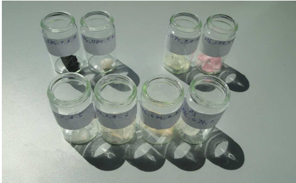
Abbildung 91: In verschiedene Polymere eingearbeitete Organo-Nanopartikel. Obere Reihe v. l. n. r.: 46a in technischem POM schwarz (1380 ppm), 46a in technischem POM natur (1400 ppm), 48a in PS (5000 ppm), 47a in PS (5000 ppm). Untere Reihe v. l. n. r.: 46a in PS (1000 ppm), 46a in PS (2500 ppm), 46a in PS (5000 ppm), reines PS. Fotoaufnahme bei direkter Sonneneinstrahlung.
