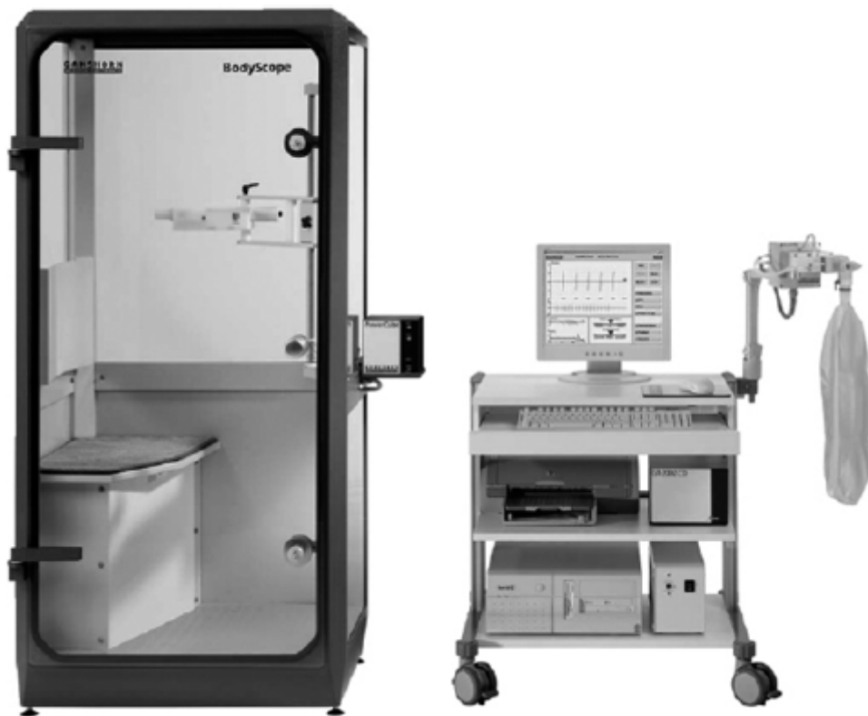
Abbildung 14 Arbeitsplatz mit Bodyplethysmograph, Computereinheit und Diffusionsmessplatz [61]
