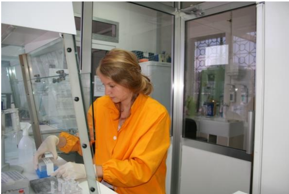
Abbildung 22: Räumlichkeit zur Präparation des Mastermix (Raum 1). Zur Gewährleistung von Kontaminationsfreiheit kommen UV-Lampen zur Zerstörung von Nukleinsäuren zum Einsatz
