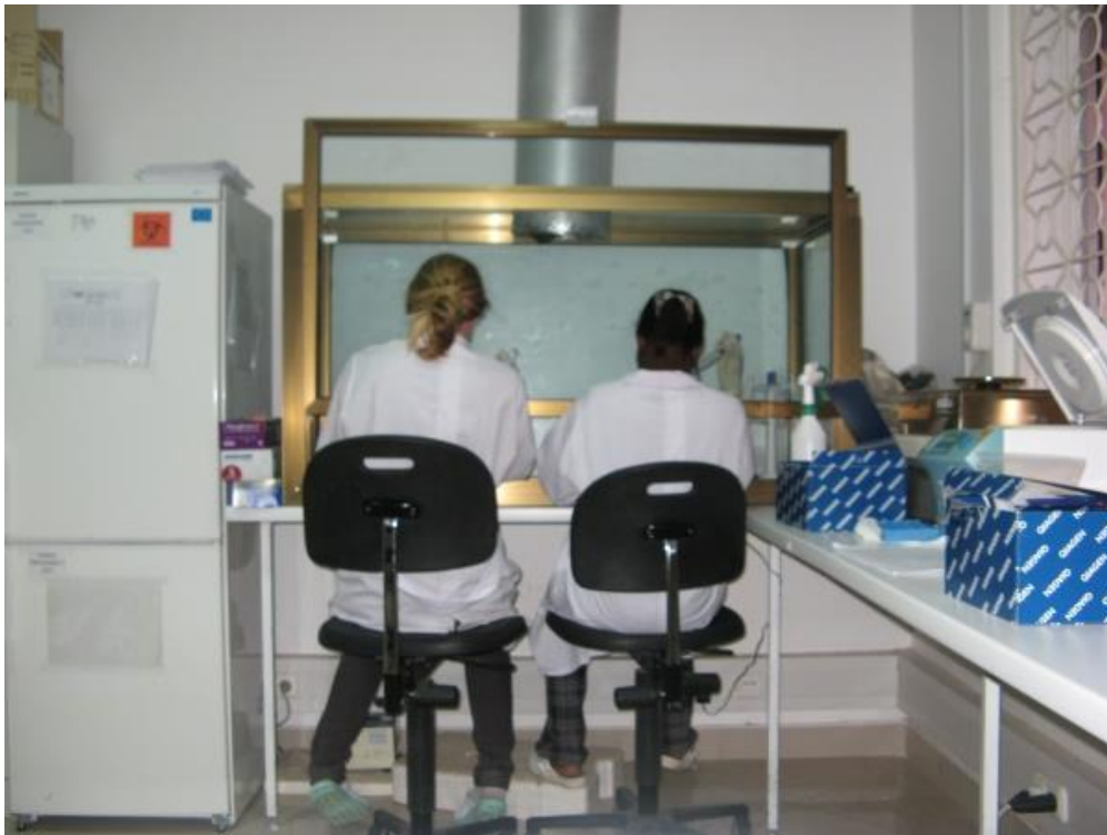
Abbildung 24: Extraktionsraum. Isolierung der DNA aus Stuhlproben unter der Abzugshaube
