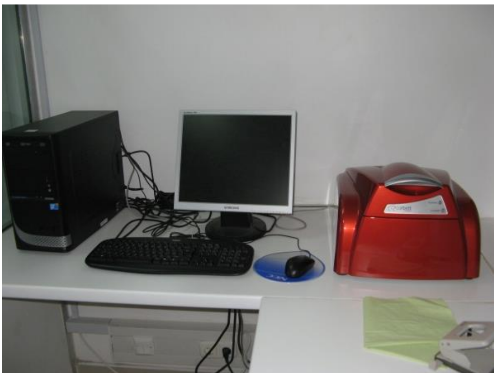
Abbildung 23: Raum 3 - Rotorgene 6000 Thermocycler der Firma Corbett Life Science. Durchführung des Real-Time-PCR-Laufs und anschließende Auswertung am Computer
