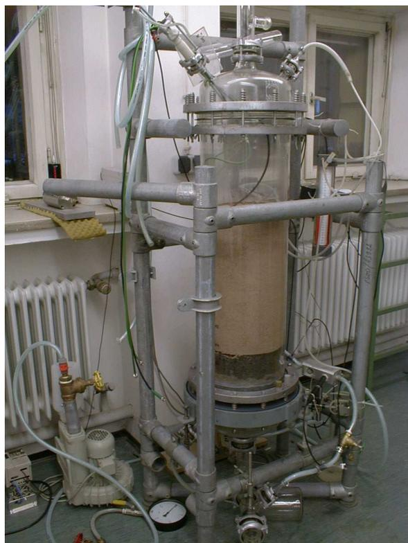
Abb. 46: Großsäulenanlage zur Bestimmung der Gasdurchlässigkeit.
