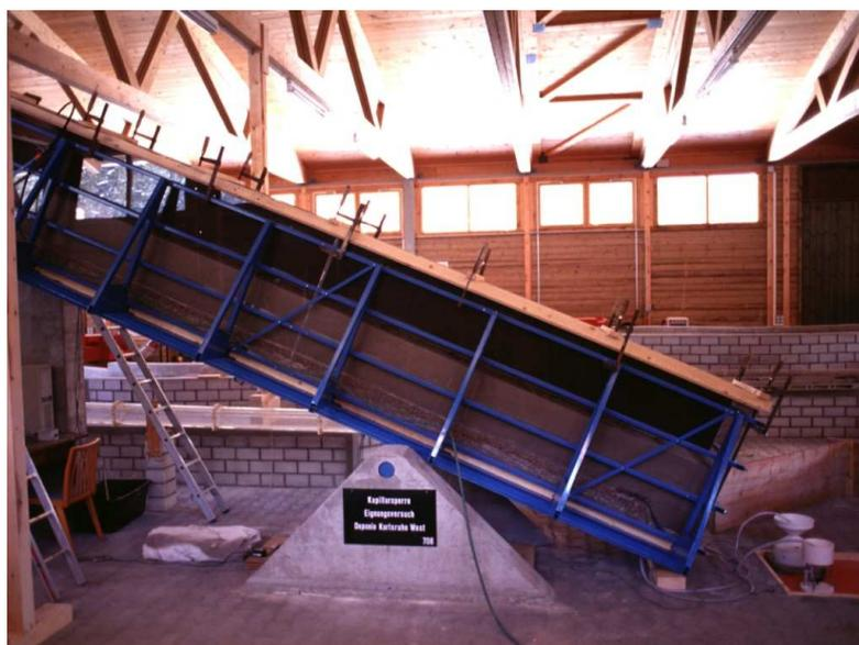
Abb. 15: Die verwendete Großversuchsrinne mit 6,0 m Länge.
