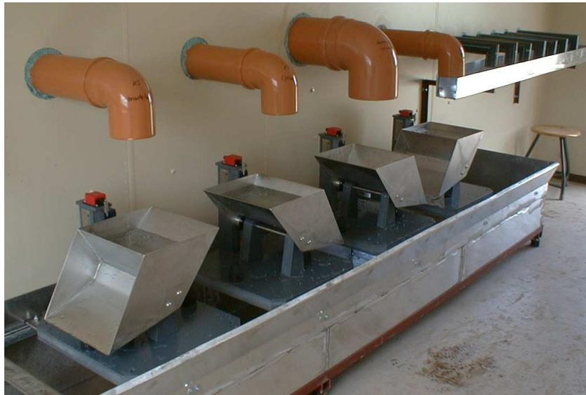
Abb. 26: Das Abflussmesssystem im Messcontainer.
