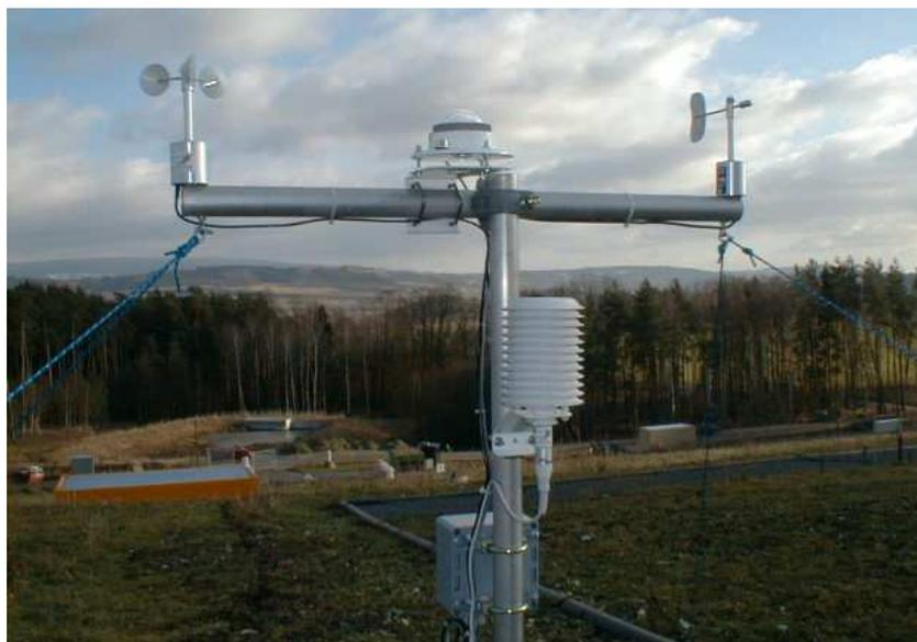
Abb. 27: Mast mit Schalensternanemometer, Sternpyranometer, Gehäuse mit Lufttemperatur-/Luftfeuchtemessung und Windrichtungsgeber (von links nach rechts).
