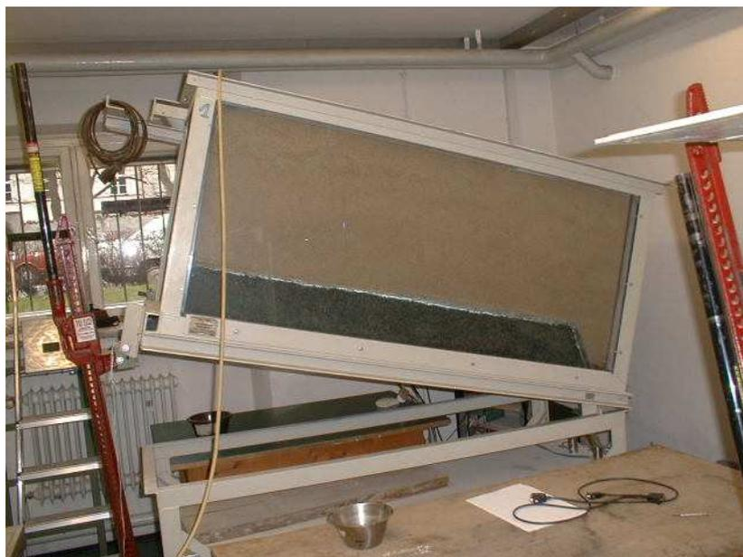
Abb. 48: Versuchstank mit eingebauter Kapillarsperre und 26 % Neigung.
