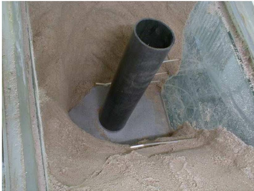
Abb. 49: Einbau des Durchdringungskörpers in die Kapillarsperre (zu sehen sind außerdem die Tensiometersonden).
