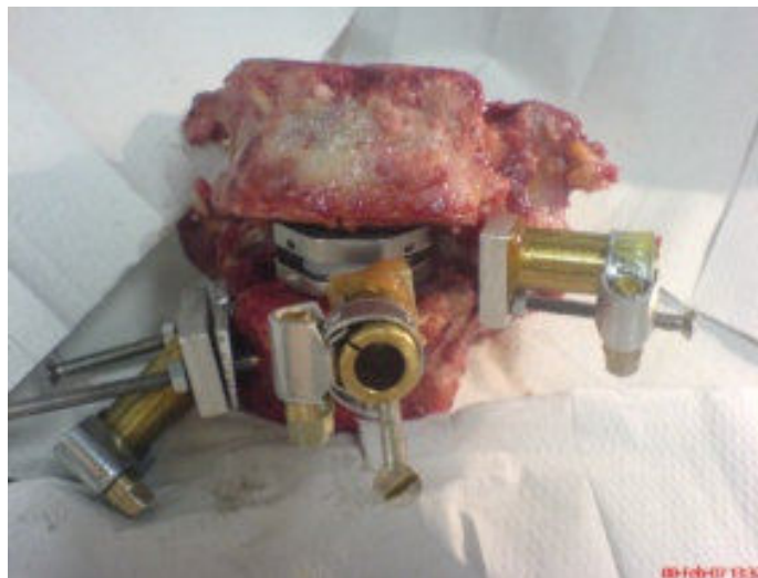
Abb. 13: Ein Präparat mit angebrachten Halterungen für Messsensoren
