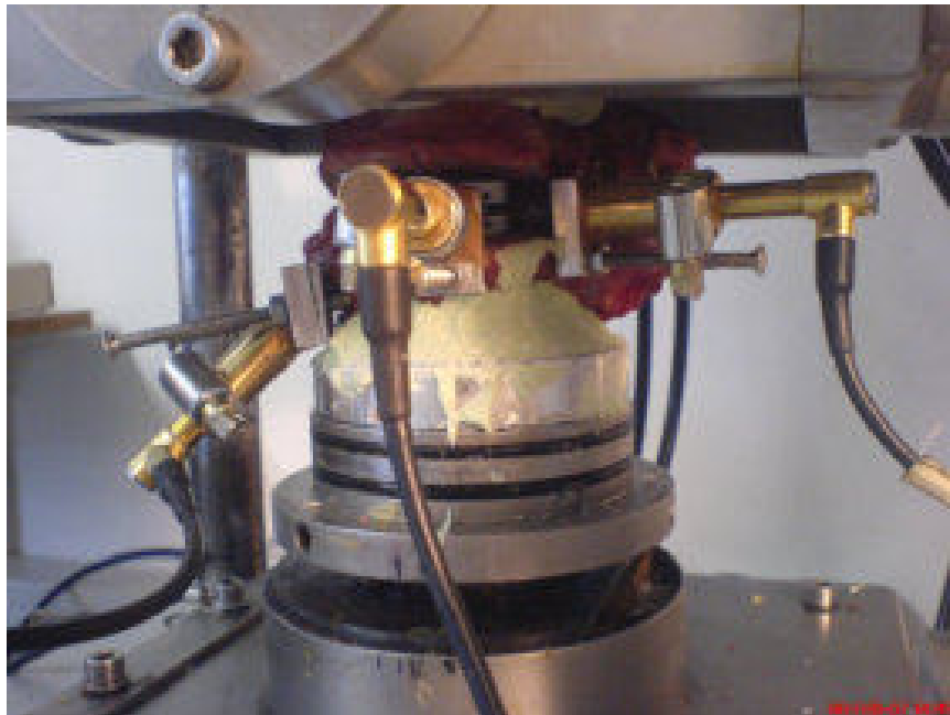
Abb. 16: Eingebautes Bewegungssegment mit angebrachten Messfühlern.
