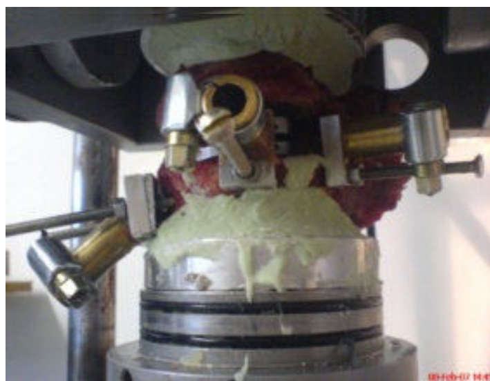
Abb. 14: Ein Präparat mit angebrachten Halterungen, eingebaut im Simulator
