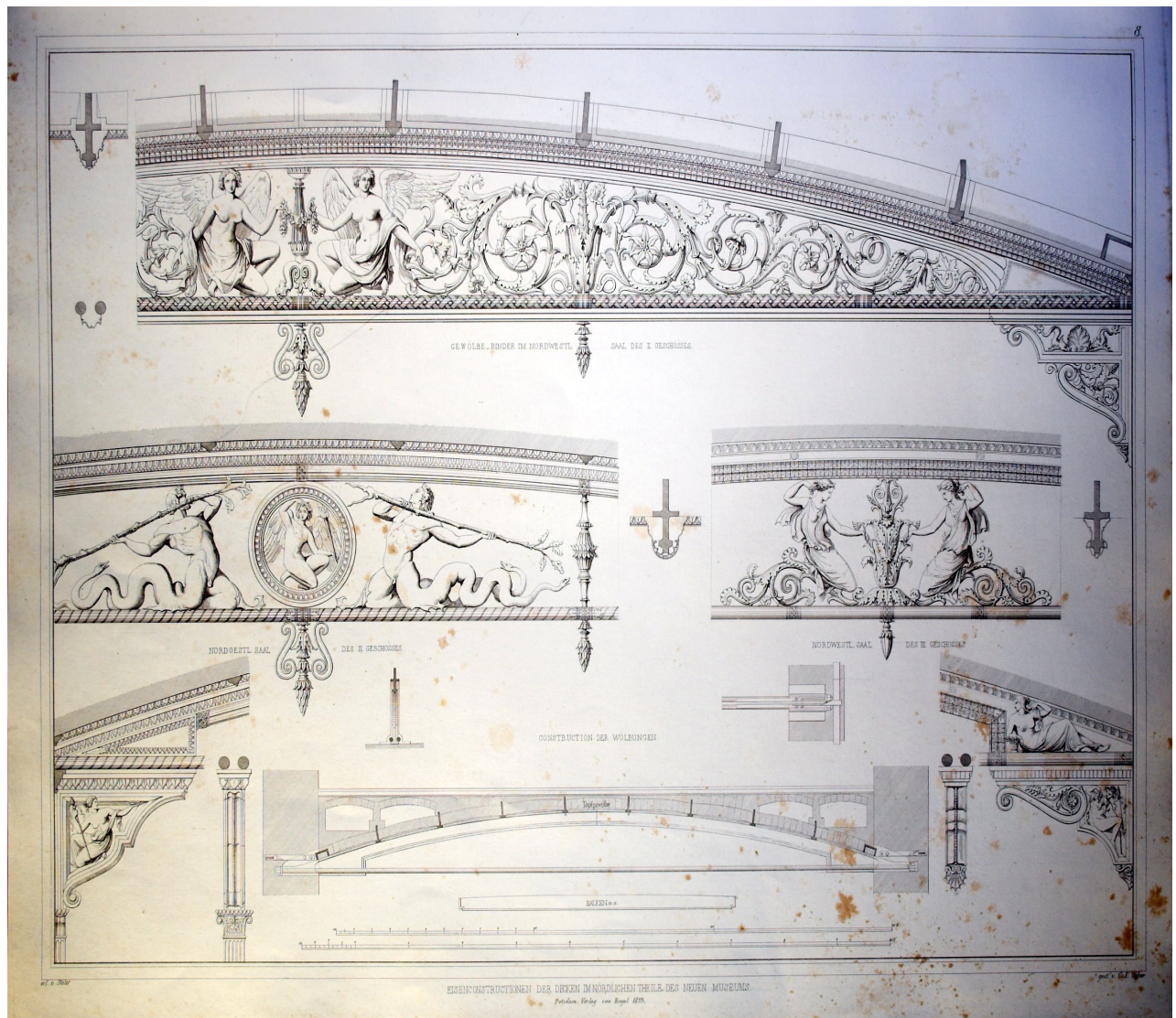
Abb. 6: Stüler, Friedrich August: Gewölbe-Binder und Eisenkonstruktionen im Neuen Museum, 1862. Aus: Stüler: Das Neue Museum in Berlin (1862) Taf. 8.
