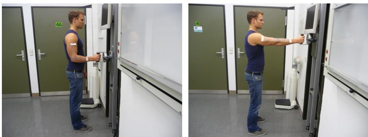
Abb. 34 a und b: Verschiedene Platzierungen der Handgriff-Drehmoment-Einheit und des Probanden, a) Der Proband steht nah an der Messeinheit, der Abstand wird durch das Einhalten der korrekten Winkeleinstellung im Ellbogengelenk
