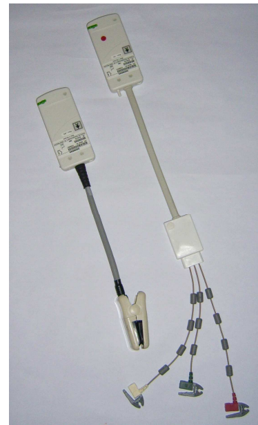
Abbildung 2.3 MR-kompatibles Pulsoxymeter Model No. 07389567, Siemens AG München (links) und MR-kompatibles EKG Model No. 07386910, Siemens AG München (rechts)
