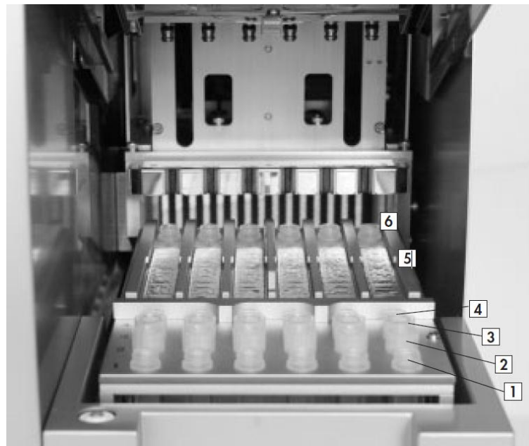
Abbildung 3: Worktable des EZ1: 1. Elutionsröhrchen, 2. Tip Holders mit Tips, 3. Frei, 4. Probengefäß, 5. Reagenzienkartusche, 6. Heizblock
